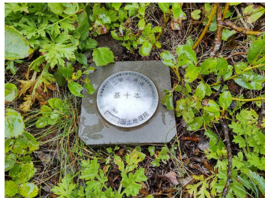
コンクリート柱に金属標を埋め込んだ新しいタイプの三角点標識
